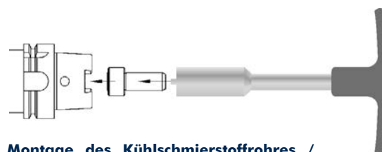
Montage des Kühlschmierstoffrohres / Assembly of the coolant pipe
