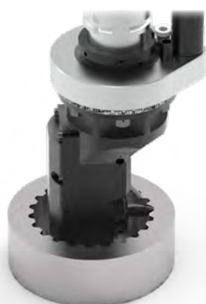
Fräsen von Zahnnabenprofilen mit Winkelkopf und Hartmetall-Zahnformfräser
