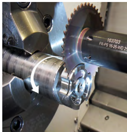
Abtrennen von VA-Formteilen V_c = 160 \text{ m/min} F_z = 0,1 \text{ mm}
