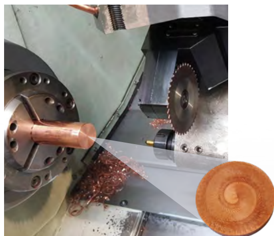
Abtrennen von CU-ETP – Formteilen V_c = 300 \text{ m/min} F_z = 0,08 \text{ mm}
