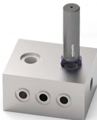
Axialeinstiche – 2-schneidige PolyMILL-Senk-Platte (Innendurchmes- ser min. 5 mm – Außendurchmesser max. 28,5 mm)
