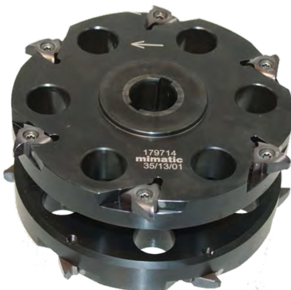
Fräsen von Flanschen eines Motorblocks mit TriMILL
