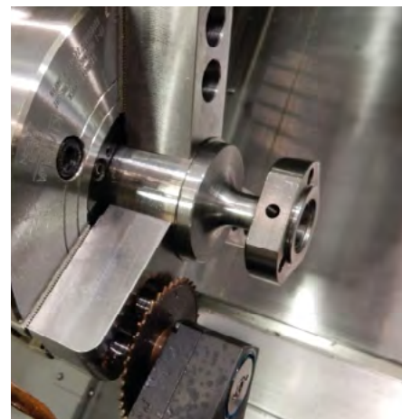
Abtrennen von Alu-Bauteilen V_c = 800 \text{ m/min} Vorschub = 7000 mm/min
